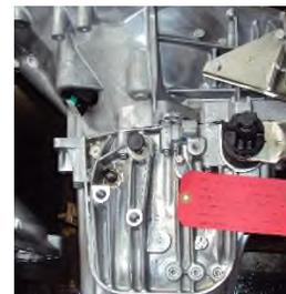
➤ à protéger les pièces usinées, les moteurs, les BV et les tables de contrôle contre les risques d'oxydation et de corps étrangers :
