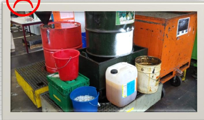
Les produits chimiques doivent être stockés selon les règles de l'IPS I\_DPTM\_RSH\_001 : volume, compatibilité, affichage FU et volume de rétention, rétentions adaptées.
